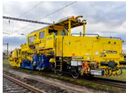
Stroj pro úpravu šterkového lože USP 2000 C2
