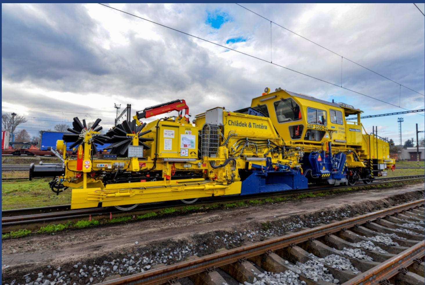
Stroj pro úpravu a doplňování štěrkového lože se strmým dopravním pásem a zásobníkem na štěrk pro kolej a výhybky.
