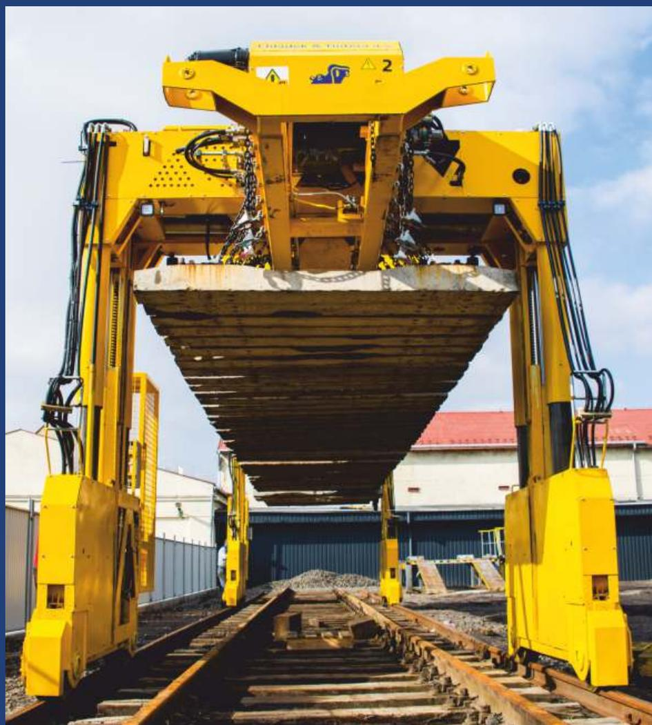
Hydraulický portálový jeřáb typu PTH 350 byl vyvinut speciálně pro obnovu kolejí a pokládku nových kolejí. Používá se tam, kde je třeba vytrhnout použitá kolejová pole a nahradit je novými, respektive pro pokládku nových dřevěných, betonových nebo ocelových pražců.
