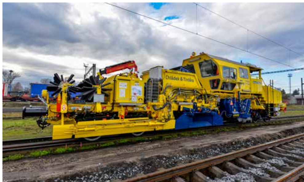
Stroj pro úpravu a doplňování štěrkového lože USP 2000 C2
