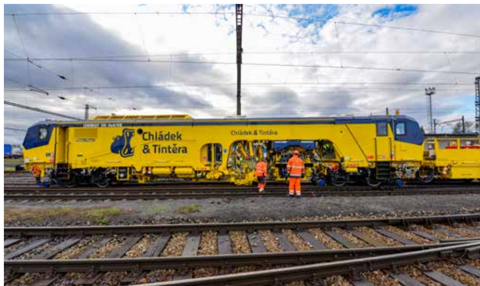
Automatická strojní podbíječka Unimat 08-4x4/4S
