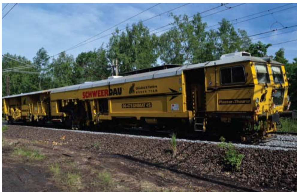
ASP. Podbiječka je schopná po vyčištění, pokládku nového či užitého materiálu anebo jiném propracování kolej nebo výhybku vyzvednout a nasměrovat, vytvořit správný poloměr oblouku a správné převýšení.
